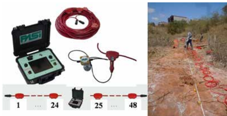
FIGURA 3. Equipamento e esquema de um perfil sísmico. Esquerda: equipamento PASI e esquema de ligações para um conjunto de 48 geofones. Direita: exemplo de um dos perfis realizados na área em estudo.
