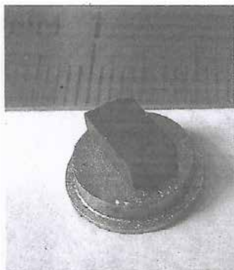
FIGURA 6. Modelo do transdutor termoelectrico com base no efeito termovoltaiico em SmS.
