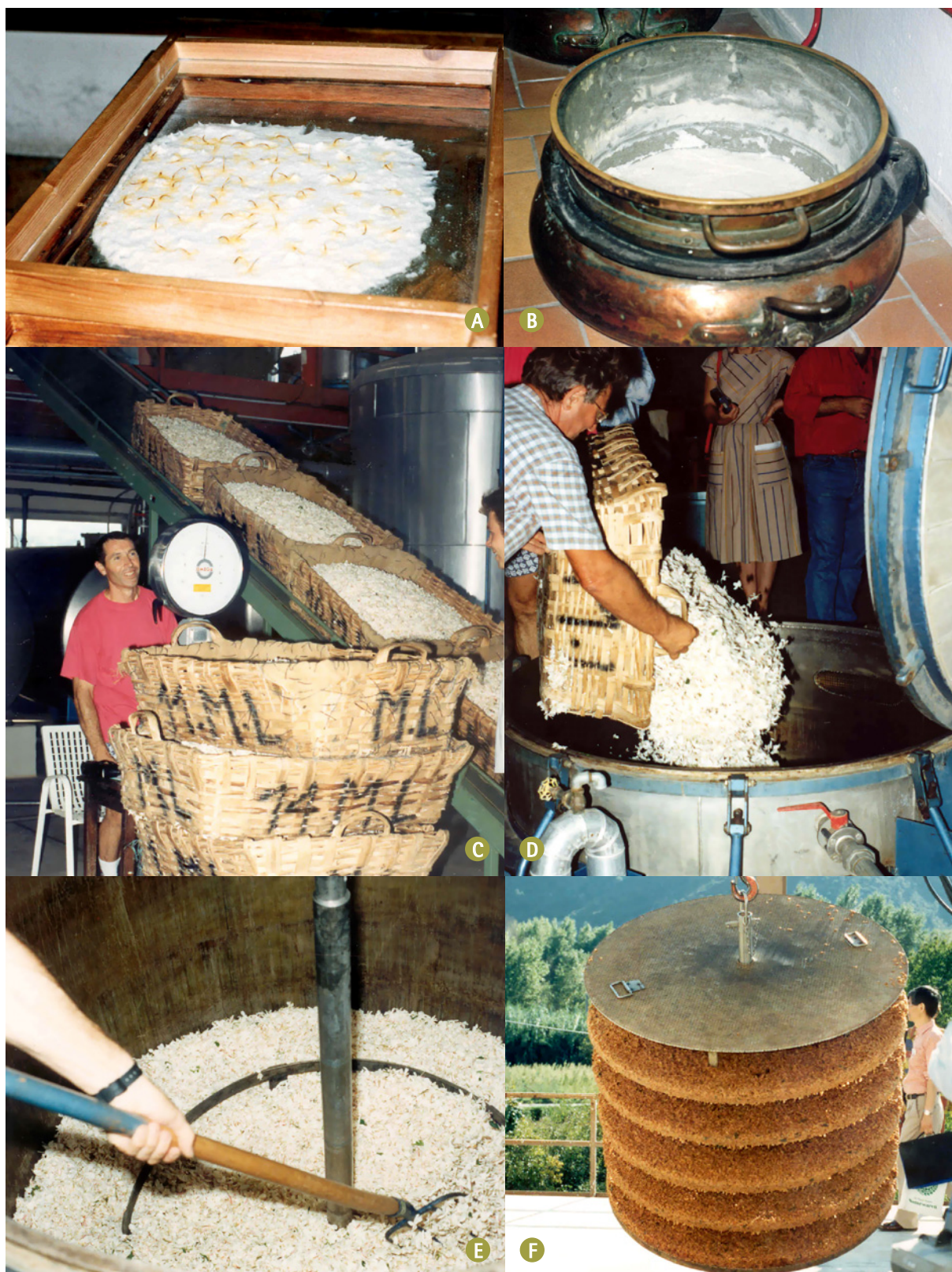
FIG. 2_ A-B) ASPECTO DE EXTRACÇÃO DE AROMA DE JASMIM POR ENFLEURAGE , A FRIO (A) E A QUENTE (B). C-F) ASPECTO DO PROCESSO DE EXTRACÇÃO INDUSTRIAL DE AROMA JASMIM, COM SOLVENTES ORGÂNICOS.
