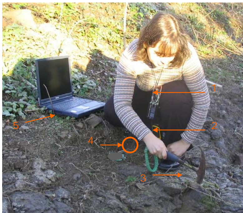
Figura 6.1 – Elemento da Equipa Remota e artefactos 1- bússola; 2 – GPS; 3 – martelo de geólogo; 4 – microfone; 5 – computador portátil com placa GPRS, SAGISc, ArcPad®
