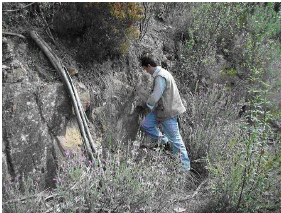
Figura 2.4 – Medição da atitude (inclinação e direcção) com bússola
