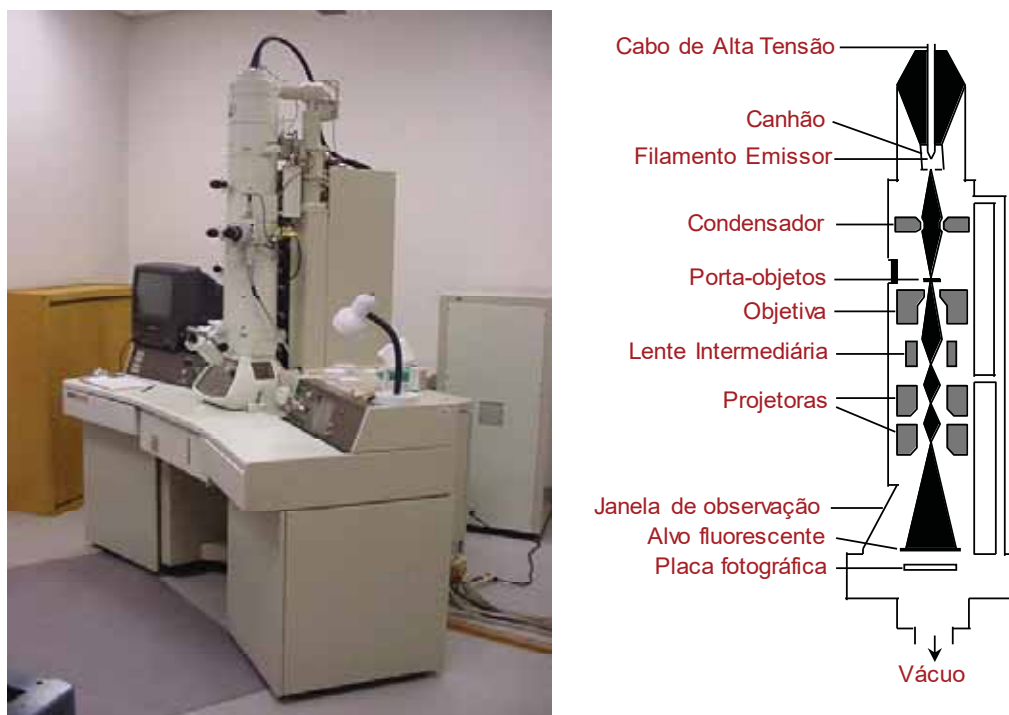
Fig. 4.2. Foto e representação esquemática do microscópio eletrónico de transmissão
